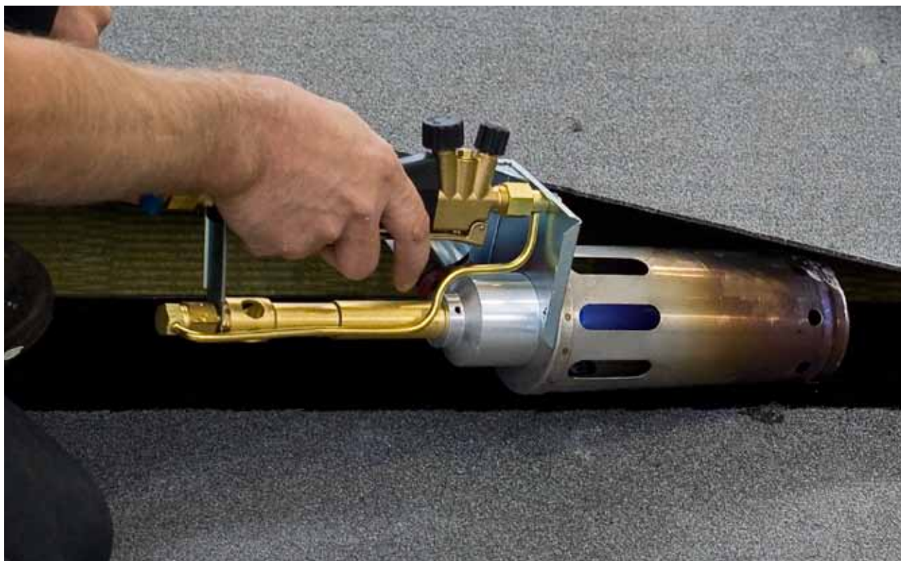
Exempel på gasolbrännare med innesluten låga, vilket är ett krav vid svetsning av tätskikt.
